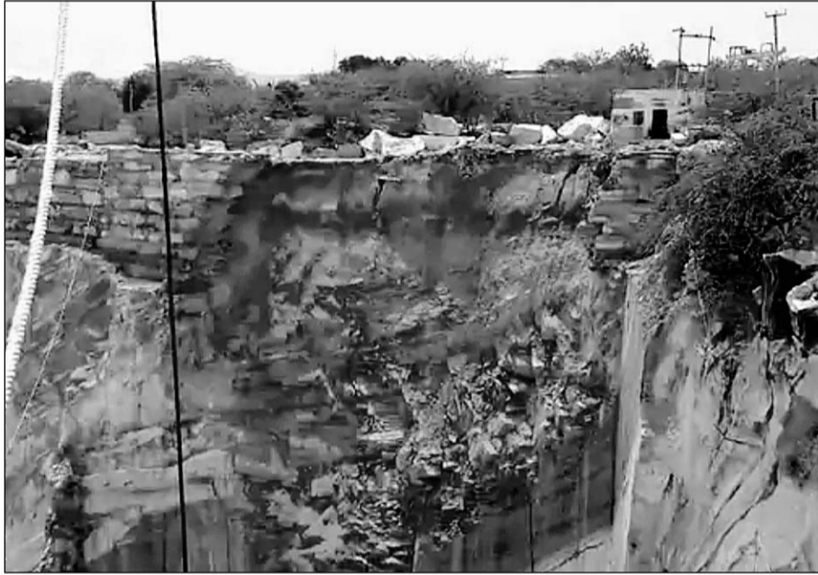
मकराना मार्बल खनन क्षेत्र के रेवत डूंगरी रेंज की मार्बल खदानों का हिस्सा गिर गया।
